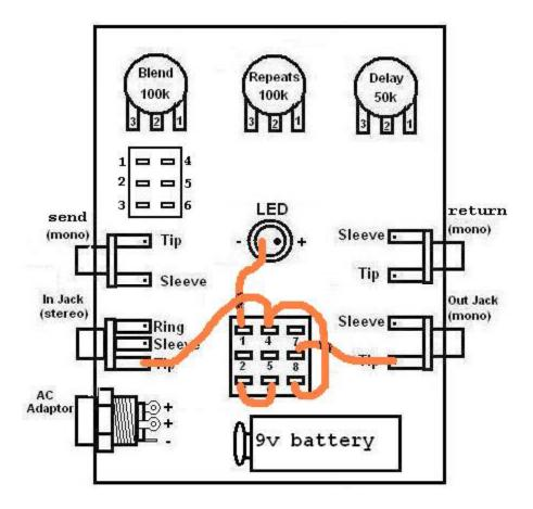
Step 1: Jumper lug3 to lug 6 Step 2: Jumper lug 9 to lug 4
